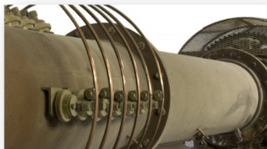
Kleiner direkt beheizter Drehrohrofen (KDO)
