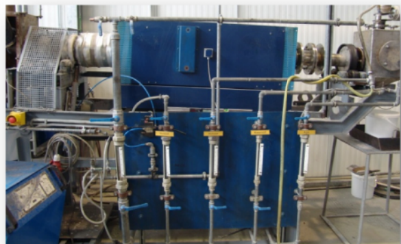
Indirekt beheizter Drehrohrofen 4 (IDO4)
